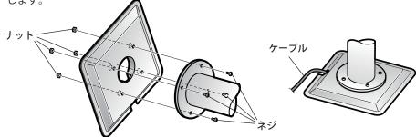
① 付属のネジは、スタンドの取り付け部の厚さが 4mm 以内の場合に使用できます。取り付け部の厚さが 4mm を超える場合は、厚さにあったネジをお客様でご用意ください。
