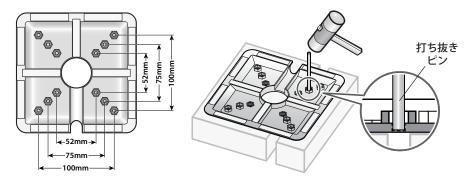
**2.** 付属のナット 4 本、ネジ 4 本を使用してスタンドを取り付けます。 ポールの穴を通して配線するタイプのスタンドを使用する場合、ここでケーブルを配線 します。
