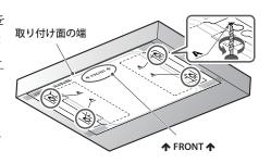
**2.** カウンターマウントキット取り付け用ネジ大 (M4-12)4 本を仮穴に仮締めします。
