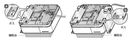
マウントフレームは本体よりも高さがあるため、補助台(厚さ 30mm 以上)の上に置くと作業がしやすくなります。
