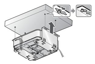
**4.** 仮締めしていた取り付け用ネジ4本を締めて固定します。
